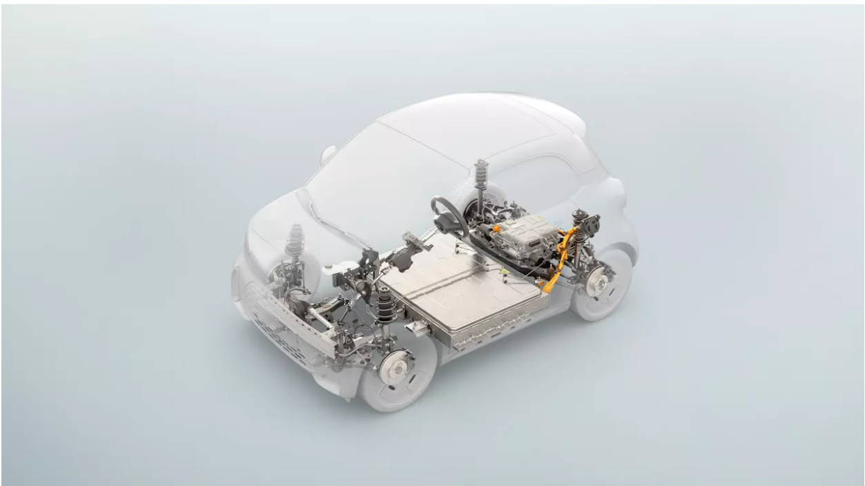
Het Electric Compact Architecture-platform (ECA) van de smart #2
