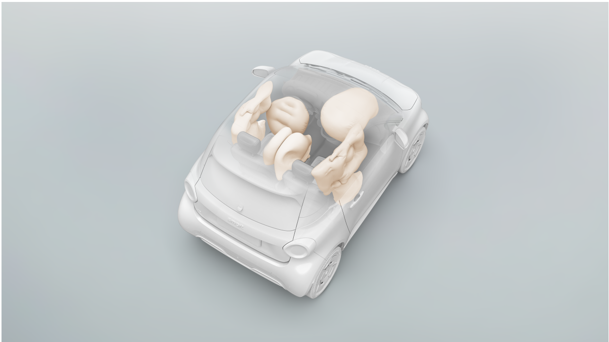
Sept airbags pour une protection maximale des occupants
