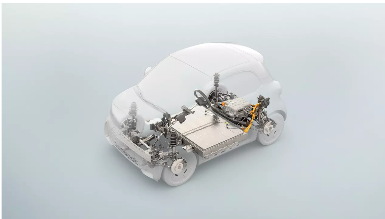
Piattaforma Electric Compact Architecture (ECA) della smart #2
