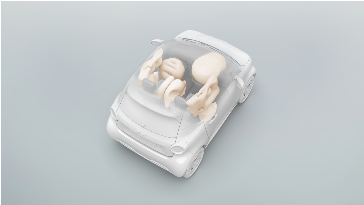
Sette airbag per la massima protezione degli occupanti
