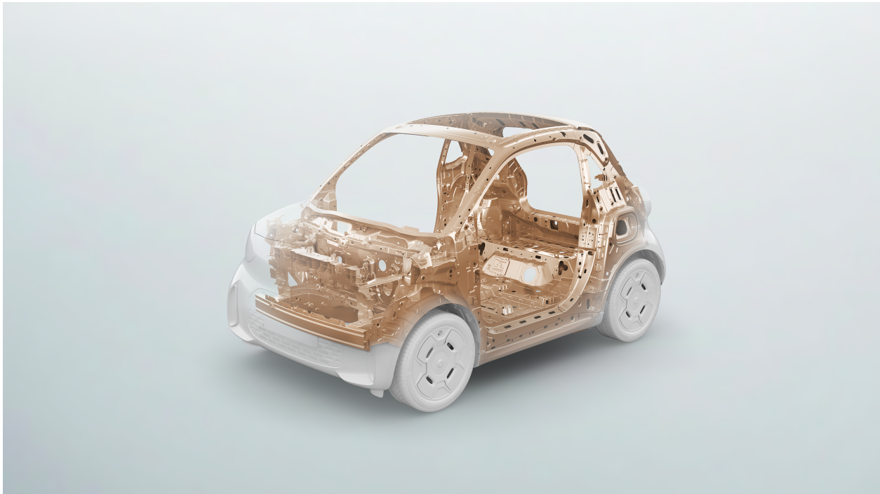
La nouvelle cellule Tridion Evo
