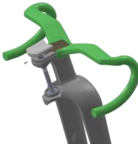
Incline el manillar hacia la izquierda o hacia la derecha e instale la cubierta de compresión con un par máximo de 1,5 Nm.
