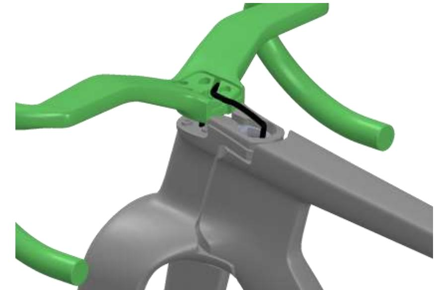
Tire suavemente del exceso de manguera del cuadro a través del manillar, acercando poco a poco los dos componentes hasta que queden bien ajustados.
