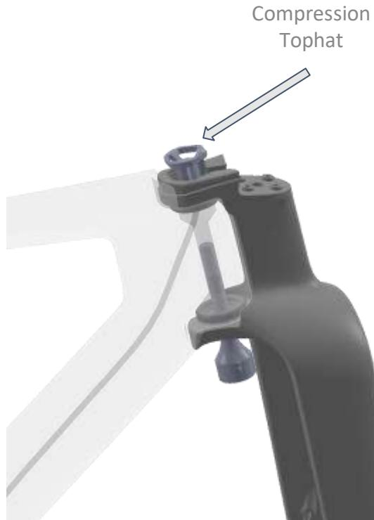
Aplique grasa dieléctrica al exterior de todos los componentes de aleación que estén en contacto con el carbono, enrosque con la mano la varilla de compresión en la tapa de compresión de centrado del cojinete superior.
