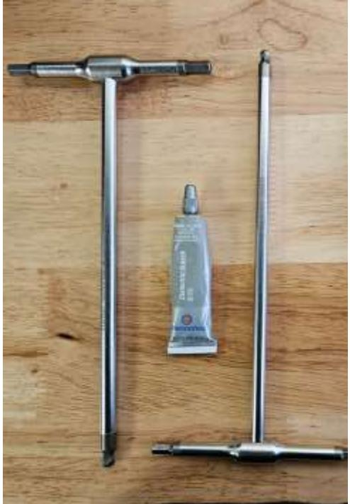
Para los siguientes pasos se recomienda utilizar llaves hexagonales con mango en T de alta calidad (6 y 5 mm). Una grasa dieléctrica de alta calidad actúa como aislante entre la varilla de compresión de aluminio y el carbono, evitando así la corrosión galvánica. Muchas grasas convencionales también tienen propiedades dieléctricas (no conductoras).
