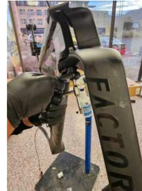
Inserte y apriete el tornillo de fijación en la parte inferior del conjunto de la barra de tensión/pinza para bloquear la pinza en su sitio. Asegúrese de que el Loc-Tite azul esté en su sitio y añada una gota si vuelve a instalarlo.
