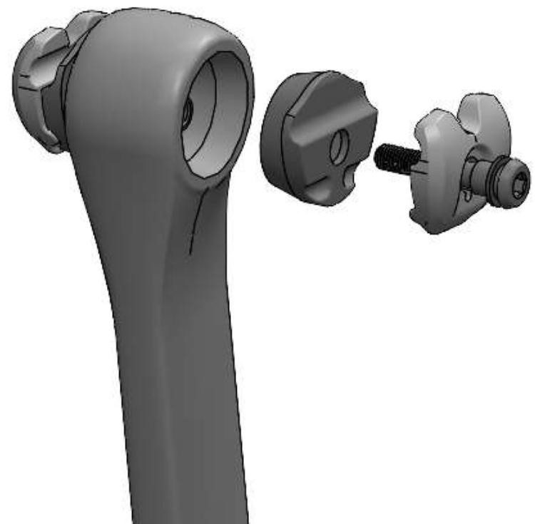
Si utiliza una configuración 1x, retire el FDM y déjelo a un lado. Instale las placas ciegas suministradas para los orificios de montaje del FD. Tenga en cuenta que puede ser útil aplicar una pequeña cantidad de adhesivo o silicona al instalarlas, ya que con el tiempo pueden aflojarse.
