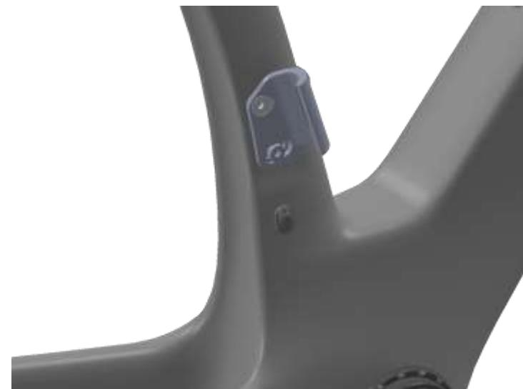
Si utiliza una configuración 1x, retire el FDM y déjelo a un lado. Instale las placas ciegas suministradas para los orificios de montaje del FD. Tenga en cuenta que puede ser útil aplicar una pequeña cantidad de adhesivo o silicona al instalarlas, ya que con el tiempo pueden aflojarse.
