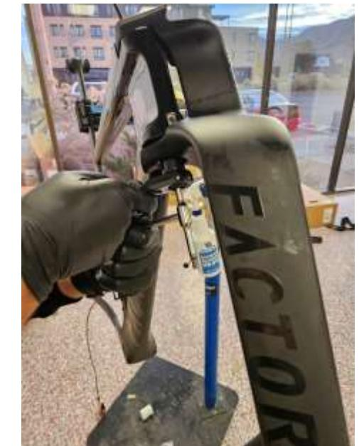
Coloque el extremo de una llave de trinquete de 14 mm o de paso en la superficie de la pinza de 14 mm. Pase una llave Allen de 6 mm a través de esta llave o vaso. Mantenga la barra de tensión estática con la llave Allen de 6 mm mientras gira y aprieta la llave de trinquete de 14 mm. Apriete hasta un máximo de 8 Nm, o hasta que quede bien ajustado. Se debe tener cuidado aquí para no girar la barra de precarga, ya que HS se apretará demasiado.
