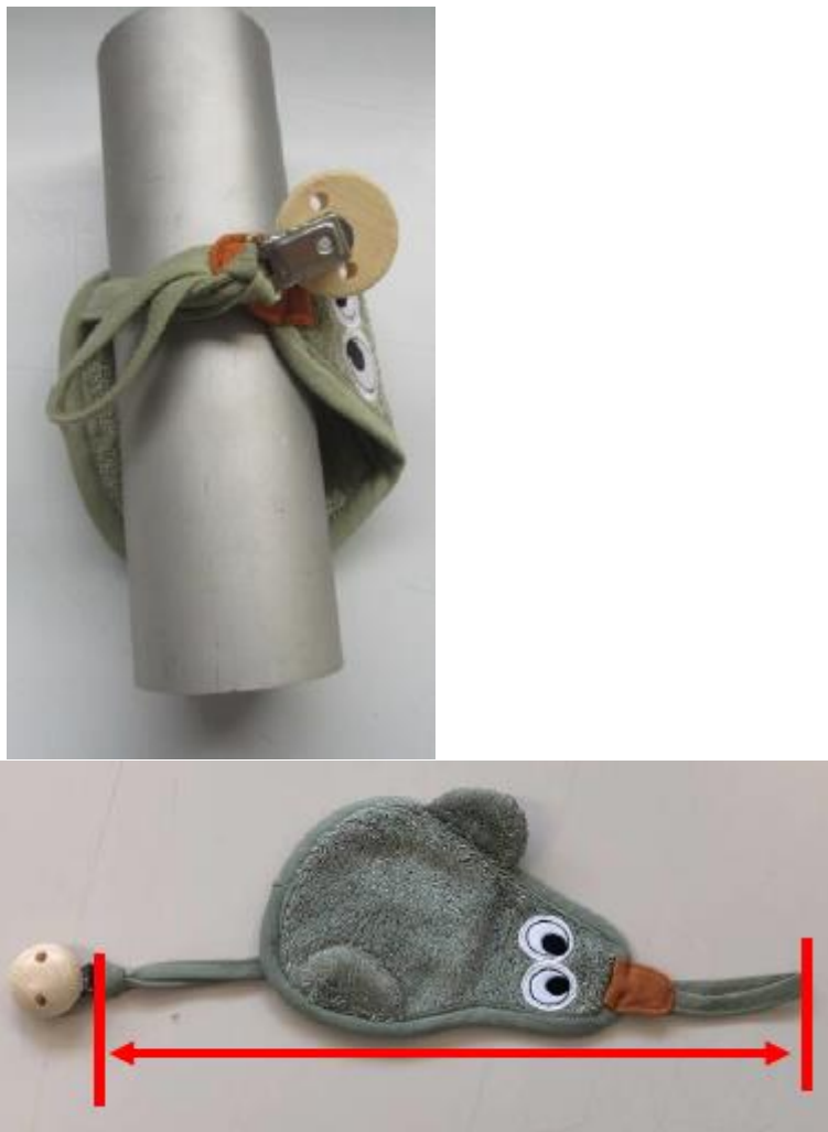
Figure 3. Illustration de non-conformités à la norme EN 12586
