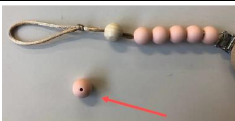
Figure 1. Illustration d'une non-conformité à la norme EN 12586
