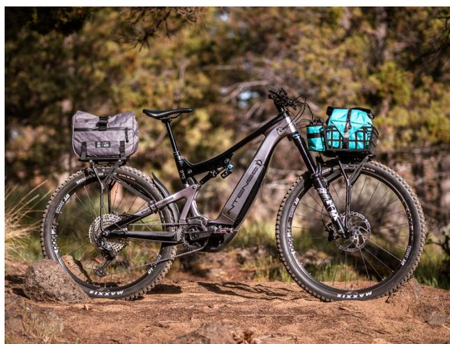
Fabricamos una línea completa de kits de montaje para montar el portabultos directamente en los bujes. Además de permitir que pongas el portabultos en cualquier bici, te ayudan a que no sobrecargues los puntos de anclaje. El portabultos está sobradamente diseñado para cargar hasta 11Kg.
