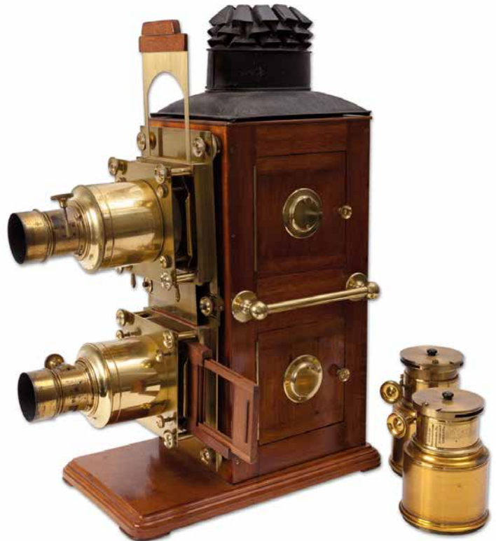
Biunial toverlantaarn (collectie Bollaert) Een toverlantaarn projecteert beelden op een glasplaat uitvergroot op een muur of doek. Deze biunial is een innovatie uit de 2e helft van de 19e eeuw en heeft meerdere lenzen. Hierdoor lijken beelden in elkaar over te vloeien.
